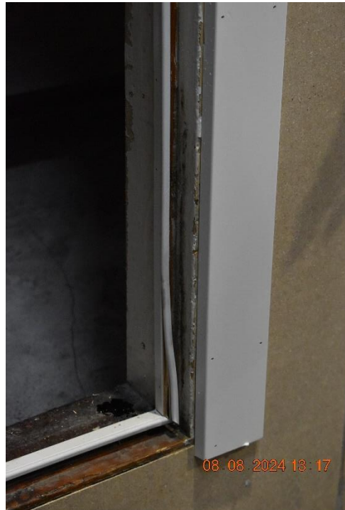
Foto nr. 29 Tætningsliste har delvist sluppet efter varm test.
