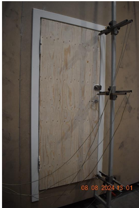
Foto nr. 27 Opstilling til test 12, inklusiv deformationsmåleudstyr.
