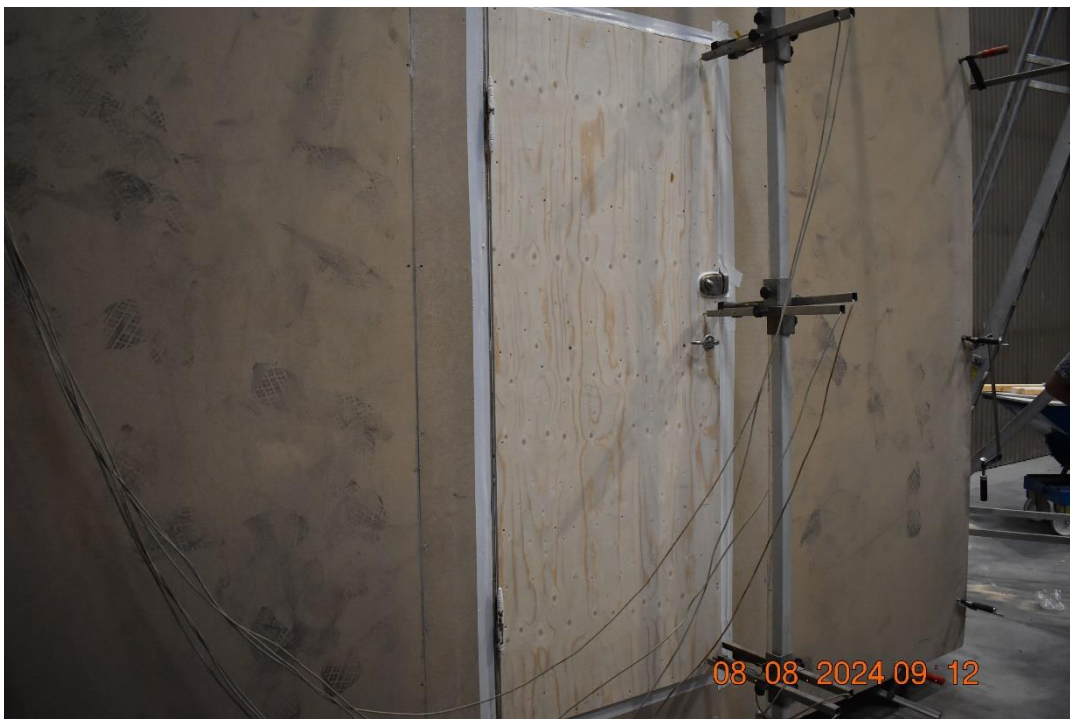
Foto nr. 20 Test 9 med dørplade med krydsfiner. Deformationsmåleudstyr opsat.
